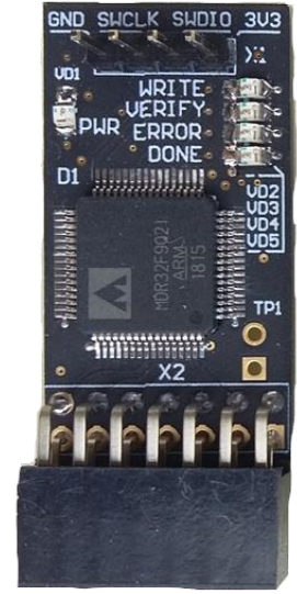
Конфигурационная память на базе МК K1986BE92QI
