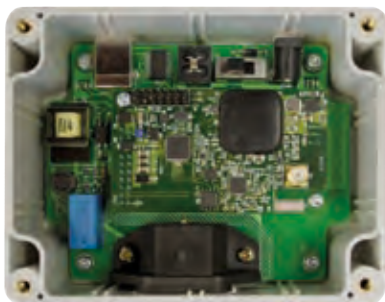
Вариант 1. Корпусное исполнение Комплект отладочный для PLC/RF модема ТСКЯ.468998.034
