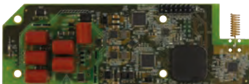
Вариант 3. Бескорпусное исполнение PLC/RF модем связи ТСКЯ.465635.005
