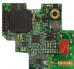
Вариант 2. Бескорпусное исполнение Модуль PLC.G3/RF868 ТСКЯ.465635.002
