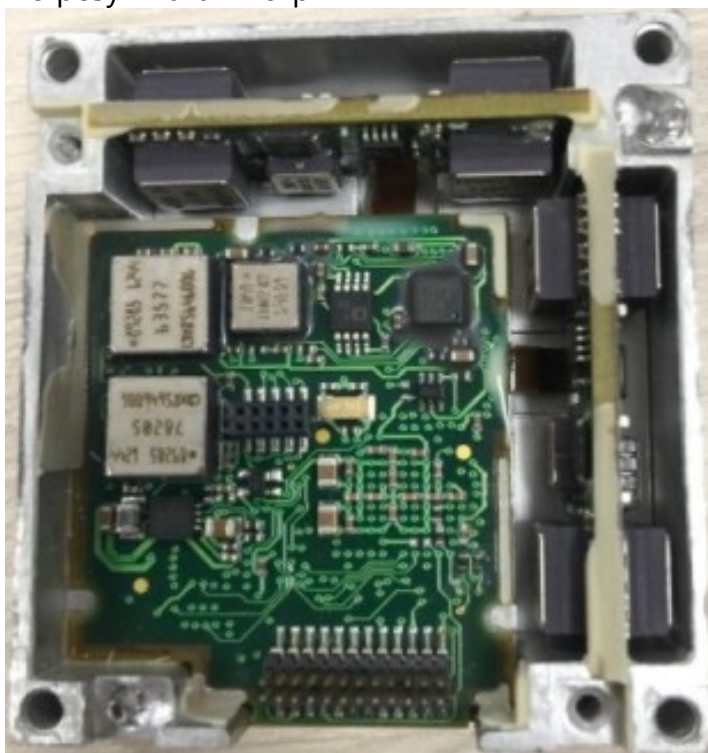
ADIS16480 со снятой крышкой
