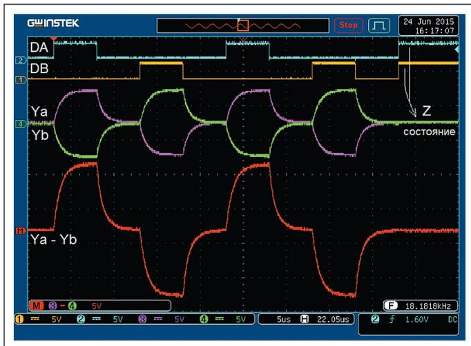
Рис. 7. Осциллограмма работы микросхемы 1586ИН2АУ при нагрузке на линии  $R_H = 600 \text{ Ом}$ ,  $C_H = 20000 \text{ пФ}$
